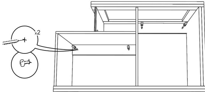
1.3 - Encoste o gabinete na parede para marcar os furos. A altura padrão para o balcão é de 65 a 70 CM.
