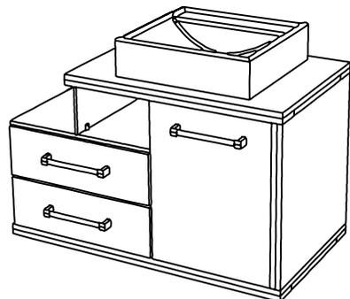
1.6 - Instale os puxadores ( A ) com os parafusos ( D ) e recoloca as gavetas do gabinete.
